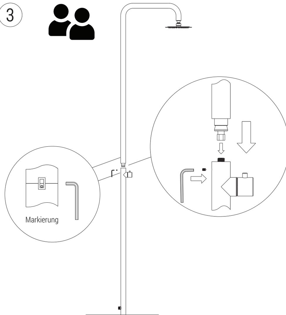
Nehmen Sie das obere Teil des Duschsystems und verbinden Sie die Überwurfmutter des Schlauchs mit den Gewindeanschluss des Unterteils.
