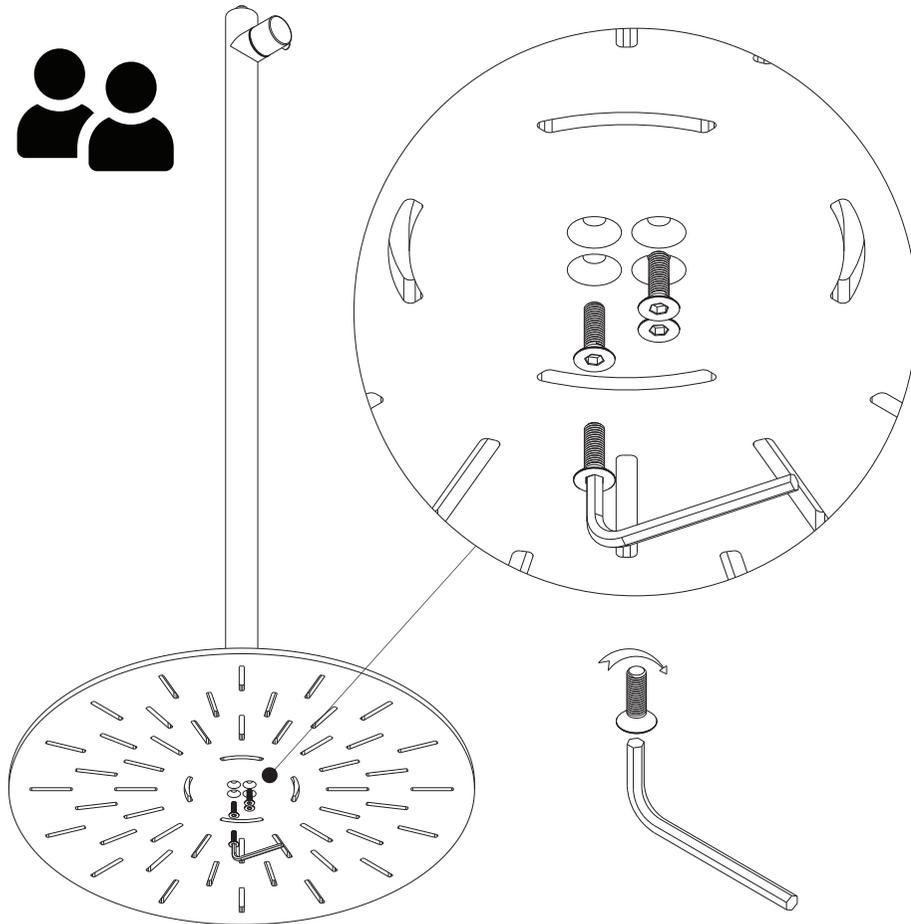
Nehmen Sie das untere Teile des Duschsystems und verbinden dieses mit Hilfe der 4 Schrauben mit der soliden Bodenplatte.
