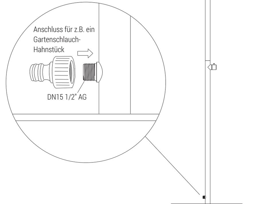
Das Duschsystem kann nun an das Wasser angeschlossen werden.
