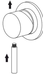
Nach erfolgter Montage des Unterputzelementes und Schließen der Wandöffnung werden die Sichtteile montiert:
